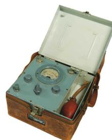
図 国内初の携帯形接触燃焼式可燃性ガス測定器 FM-1 型
